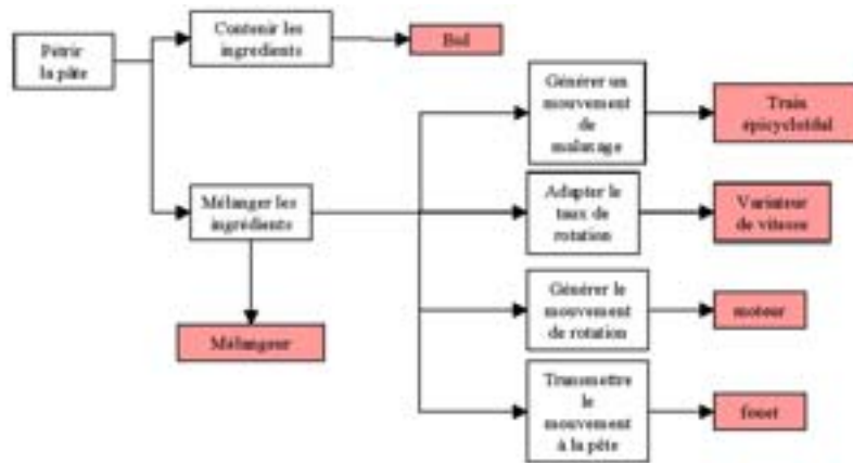
Figure I-18 : Décomposition de la fonction « Mélanger les ingrédients »
