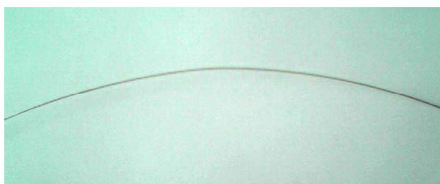
Figure 5.12 : Courbure du composite filamentaire SCS-6/Ti6242S brut d'EGV
