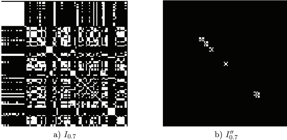
FIG. 3.4: Exemple de filtrage morphologique d'une image binaire avec un élément structurant en forme de "X" de taille  $3 \times 3$ . a) Image binaire correspondant à un seuillage de la matrice de distance à  $t = 0.7$ , b) Résultat de la suppression des blocs carrés et de l'ouverture morphologique.
