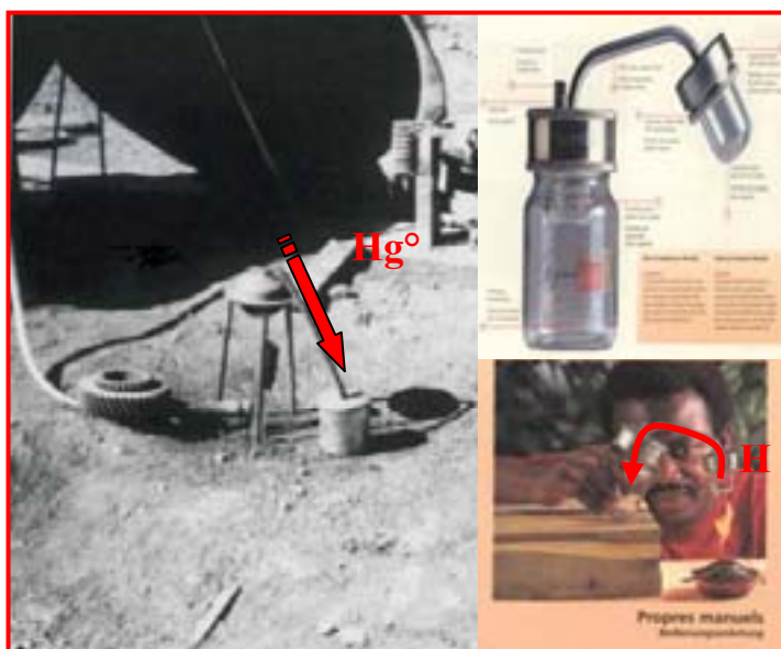
Figure 15 : Différents types de retorte, utilisés pour le recyclage du Hg^{\circ} lors du brûlage de l'amalgame (d'après Lacerda et Salomons 1998 ; modifié)
