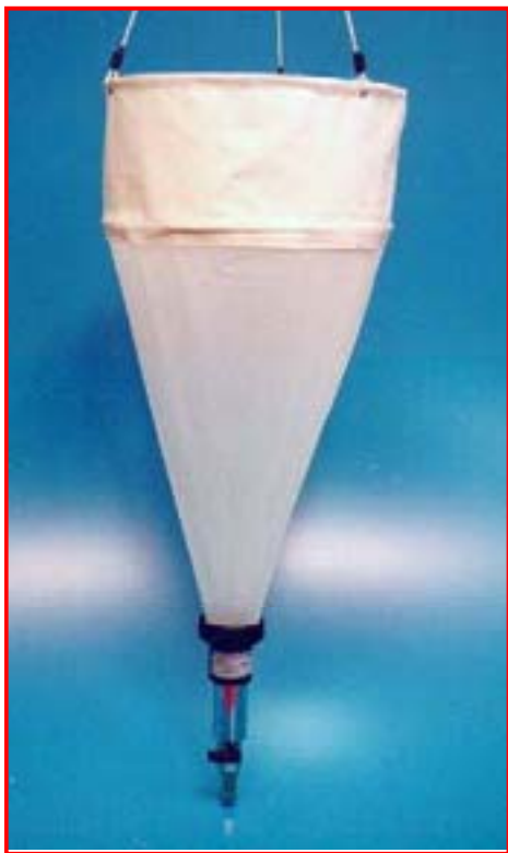
Figure 41 : Filet à plancton utilisé pour la collecte des organismes pélagiques dans la retenue de Petit-Saut.
