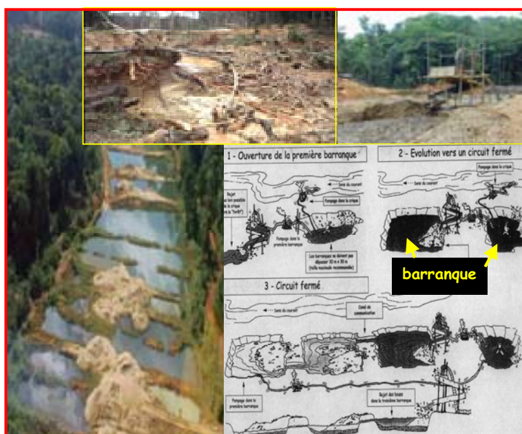
Figure 16 : Ensemble de barranques sur un site alluvionnaire d'extraction d'or en Guyane française (document DRIRE et photos « Programme Mercure en Guyane » ; modifié).
