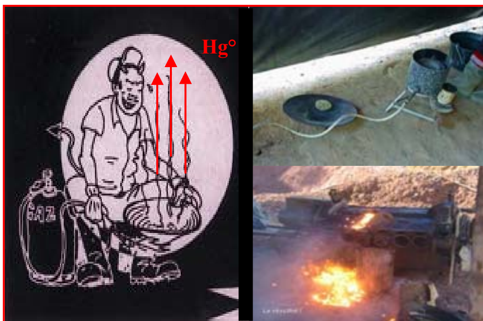
Figure 14 : Etape de brûlage de l'amalgame à ciel ouvert (document DRIRE, modifié).
