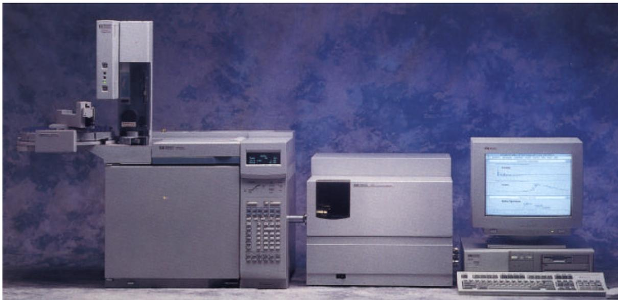
**Figure II-1: Présentation du couplage GC-MIP-AED Hewlett-Packard (Agilent Technologies, Willmington, DE, USA).**
