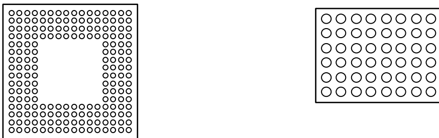
Figure III-4 : Réseau de billes du PBGA192 à gauche, et du CSP48 à droite
