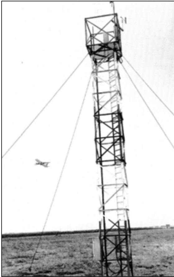
Pylône de dix mètres pour la mesure du vent, ici à Roissy. (Photo Météo-France, P. Taburet)
