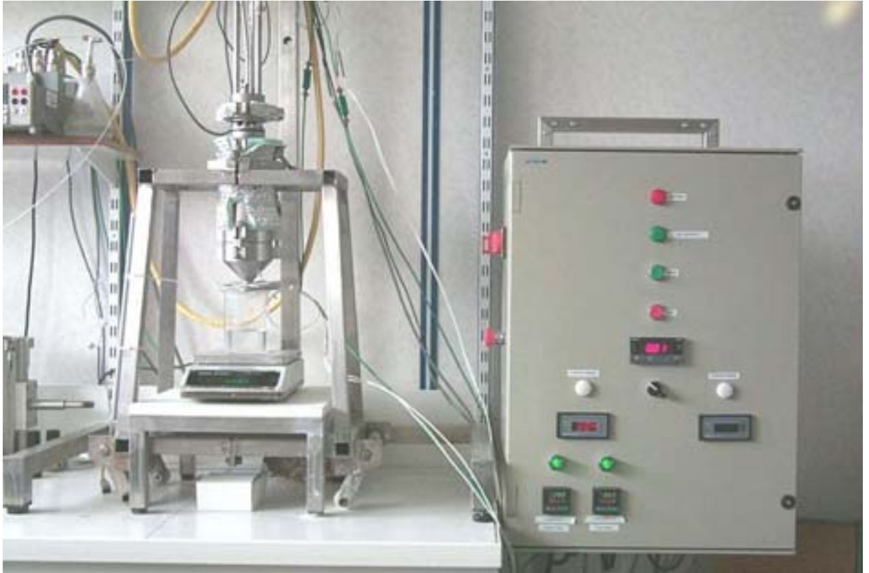
Fig. III.12. Photo du dispositif de filtration – compression assistée thermiquement.
