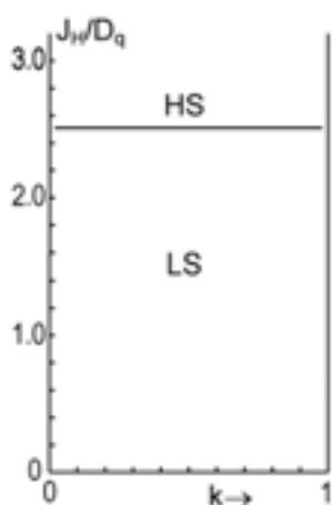
Figure I-6 : Diagramme de phases correspondant en fonction de l'échange corrélacion ( $J_H$ ), du champ cristallin ( $D_q$ ) et du paramètre de distorsion ( $k$ ) des énergies des deux configurations  $3d^7$  en symétrie  $O_h$  ( $k=0$ ) et  $C_{4v}$  ou  $D_{4h}$  ( $0 < k \leq 1$ ).
