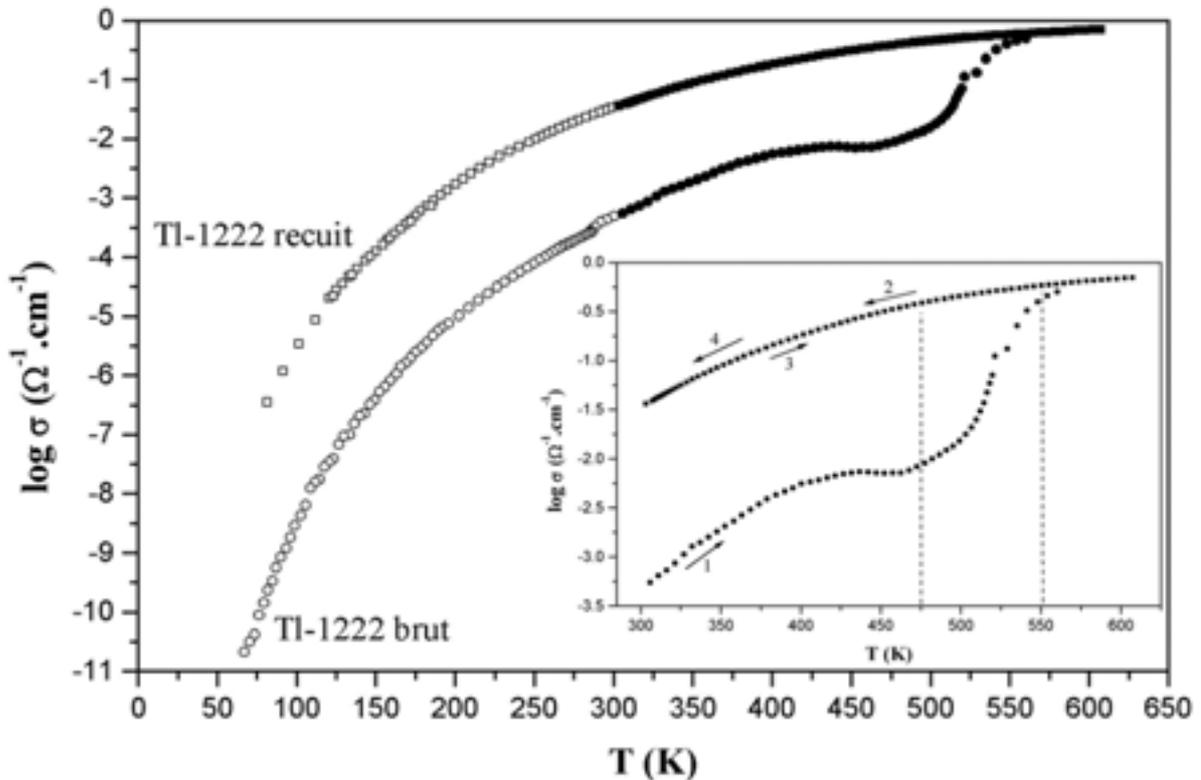
Figure V-7 : Evolution thermique de la conductivité électrique des phases Tl-1222 entre 70 et 600K. En encart, évolution irréversible de la conductivité de Tl-1222 brut à partir de 475K.
