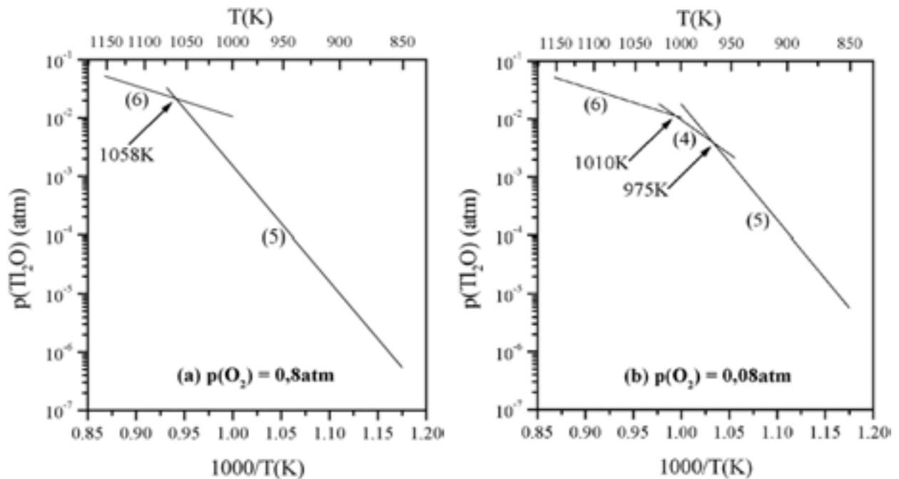
Figure III.1 : Evolution avec  $T$  de la pression partielle de  $\text{Tl}_2\text{O}$  à  $p(\text{O}_2)$  constante.
