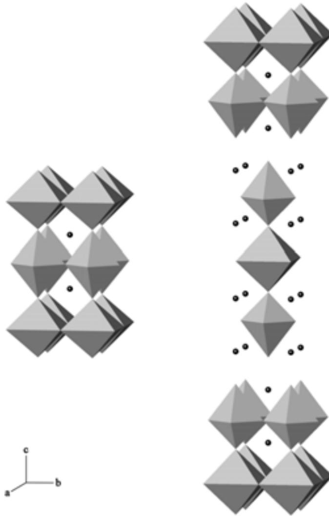
Figure II.5 – Structure des phases Tl-1201 et Tl-1222.
