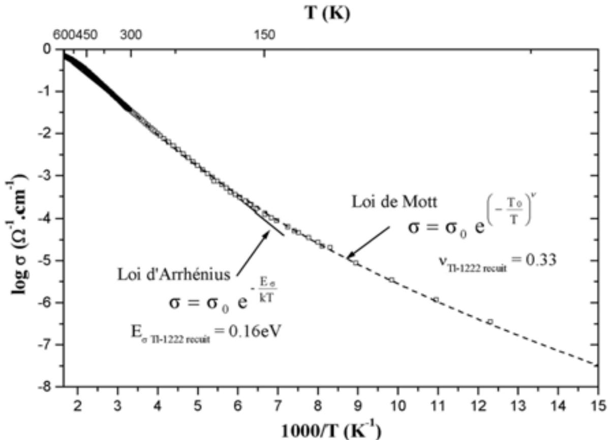
Figure V-9 : Conductivité de Tl-1222 recuit dans le domaine de basse température.
