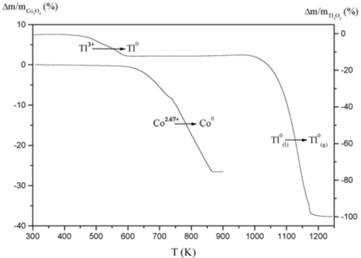
Figure III.7 : ATG sous atmosphère réductrice de Tl<sub>2</sub>O<sub>3</sub> et Co<sub>3</sub>O<sub>4</sub>
