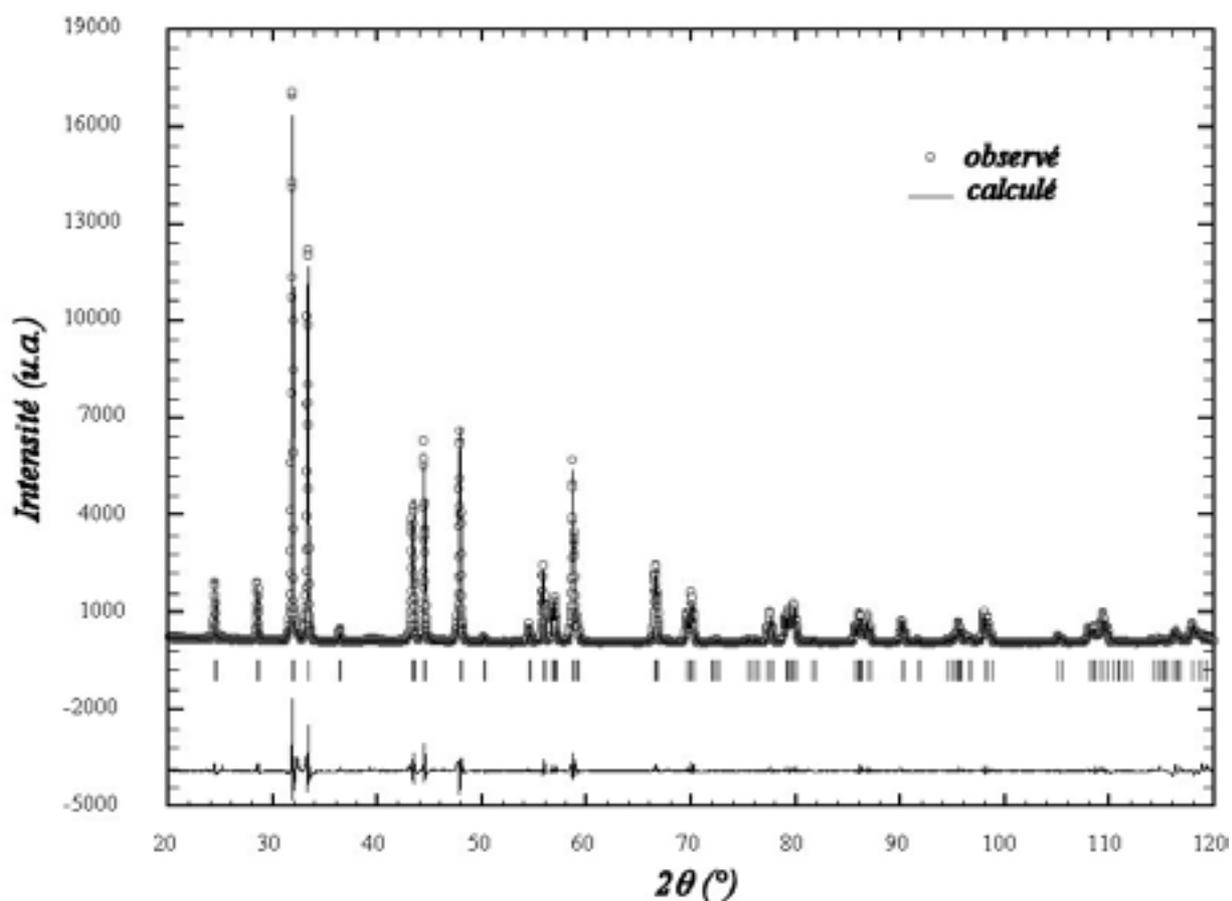
Figure IV.11 :Diffractogrammes expérimental, calculé et différence pour  $Sr_{1.5}La_{0.5}CoO_{3.98}$ .
