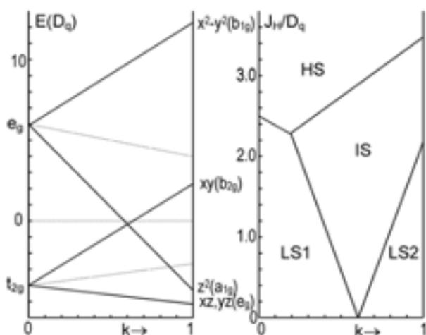
Figure I-5 : Energies des orbitales d'une configuration  $3d^6$  en fonction de  $k$  en symétrie  $O_h$  ( $k=0$ ) et  $D_{4h}$  ( $0 < k \leq 1$ ) (à gauche) et diagramme de phases correspondant en fonction des paramètres d'échange-corrélation ( $J_H$ ), de champ cristallin ( $D_q$ ) et de distorsion ( $k$ ) (à droite).
