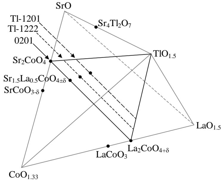
Figure III.6 : Pseudo-diagramme de phase des oxydes  $SrO-(La_2O_3)_{0.5}-(Tl_2O_3)_{0.5}-(Co_3O_4)_{0.33}$ .
