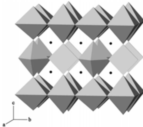
Figure II.6 - Structure de la phase  $TlSr_2NiO_{5-\delta}$  orthorhombique.
