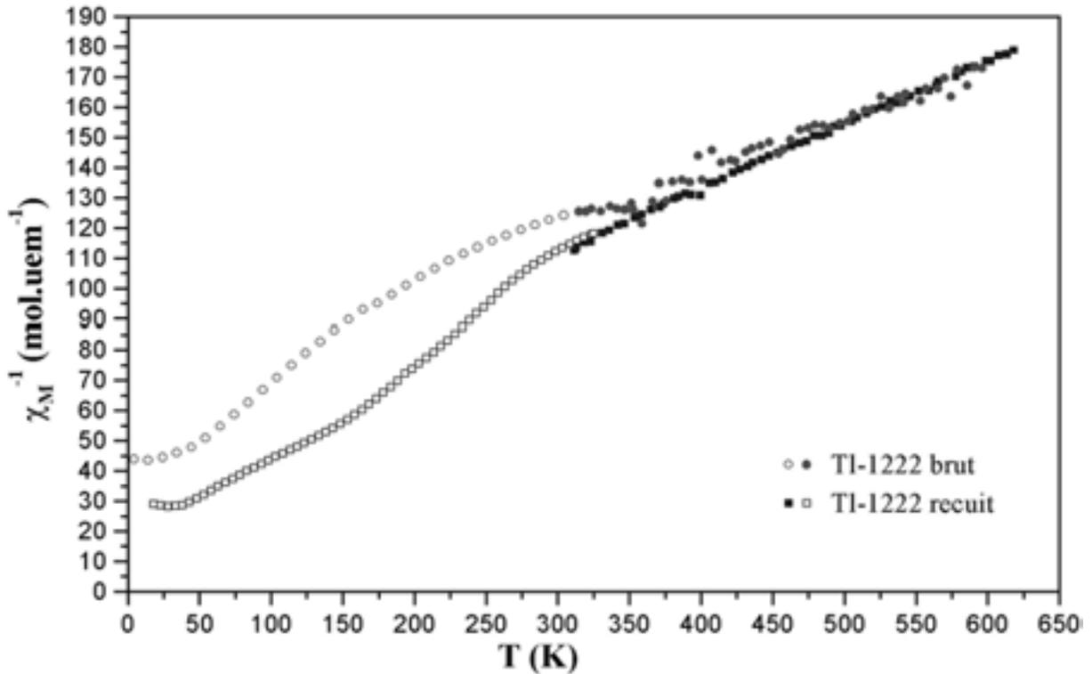
Figure V-4 : Inverse de la susceptibilité molaire des échantillons Tl-1222 brut et recuit en fonction de la température entre 4 et 600K.
