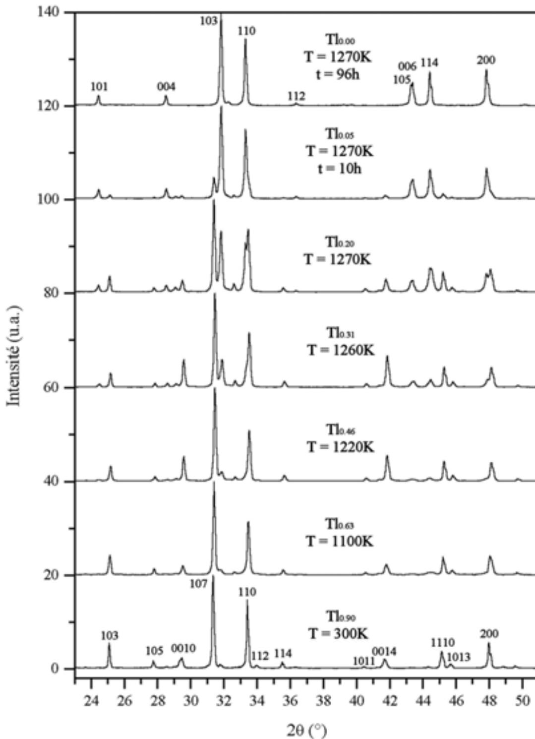
Figure IV.9 : Evolution des diffractogrammes des produits de décomposition de  $Tl_{0.9}Sr_3LaCo_2O_{8.6}$  en fonction du taux de thallium.
