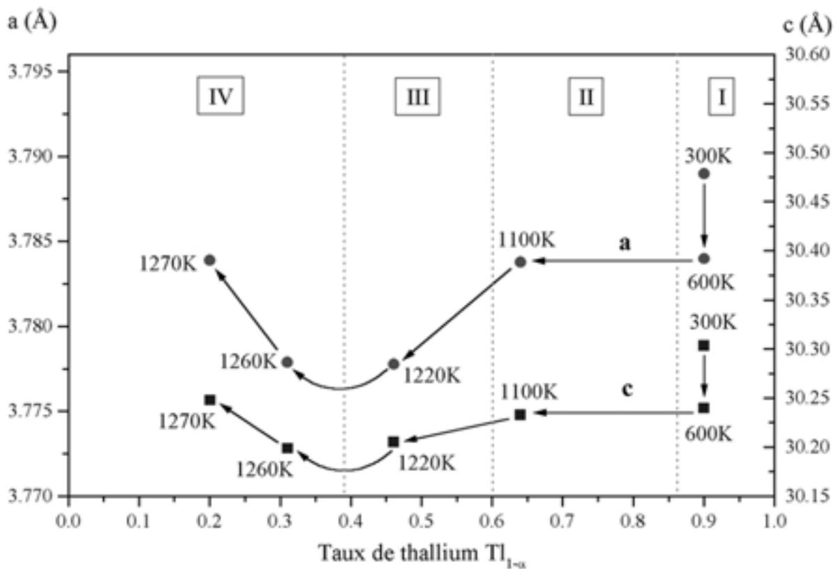
Figure IV.10 : Evolution des paramètres de maille de  $Tl_{1-\alpha}Sr_3LaCo_2O_{9-\delta}$ .
