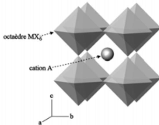
Figure II.1 – Représentation de la structure perovskite.
