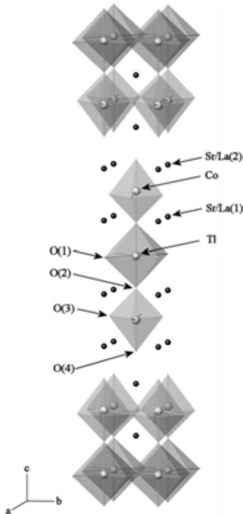
Figure IV.5 : Structure affaînie de la phase  $Tl_{0,9}Sr_3LaCo_2O_{8,6}$  à 300K.
