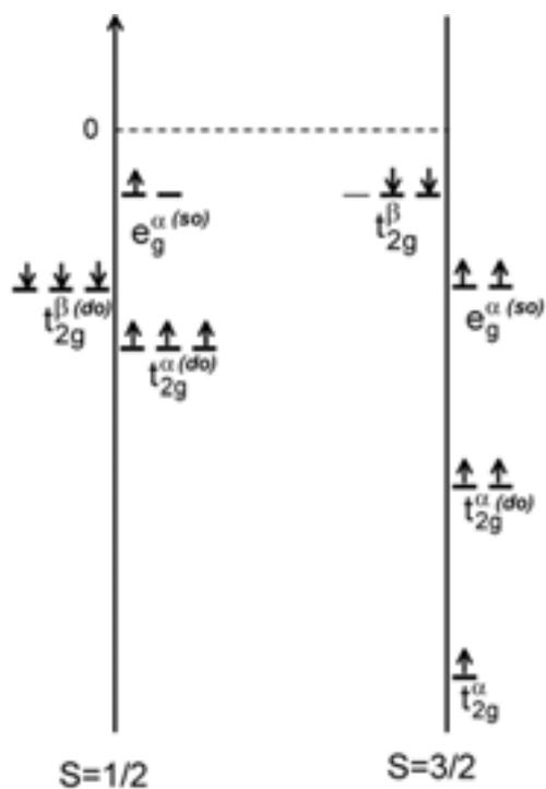
Figure I-7 : Niveaux d'énergie des électrons d pour une configuration  $3d^7$  pour  $J_H/D_q = 2,5$ .
