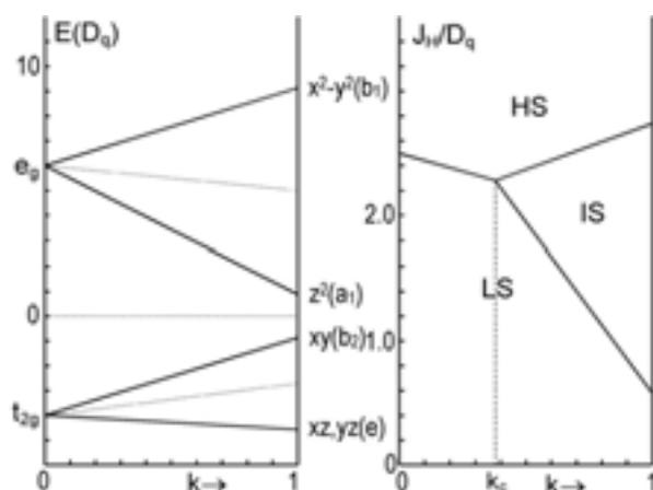
Figure I-2 : Energies des orbitales  $d$  d'une configuration  $3d^6$  en fonction de  $k$  en symétrie  $O_h$  ( $k=0$ ) et  $C_{4v}$  ( $0 < k \leq 1$ ) (à gauche) et diagramme de phases correspondant en fonction des paramètres d'échange-corrélation ( $J_H$ ), de champ cristallin ( $D_q$ ) et de distorsion ( $k$ ) (à droite).
