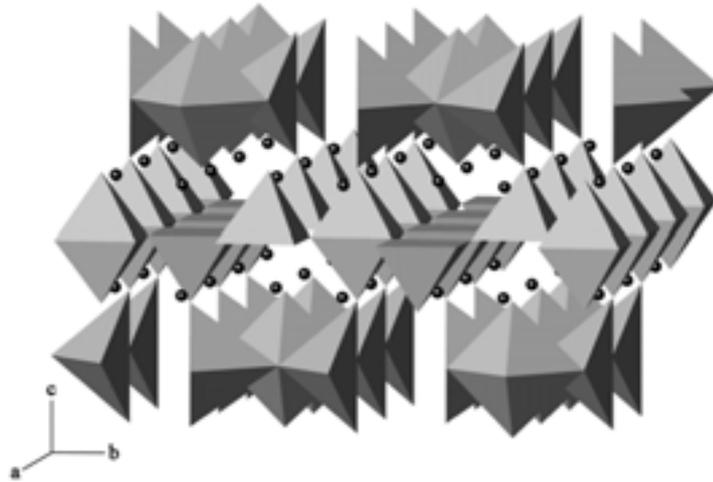
Figure II.7 – Structure de la forme basse température de  $TlSr_2CoO_5$ .
