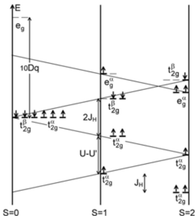
Figure I-1 : Niveaux d'énergie des électrons  $d$  pour une configuration  $3d^6$  en symétrie  $O_h$  en tenant compte des paramètres d'échange ( $J_H$ ), de corrélation ( $U$  et  $U'$ ), et de champ cristallin ( $D_q$ ).
