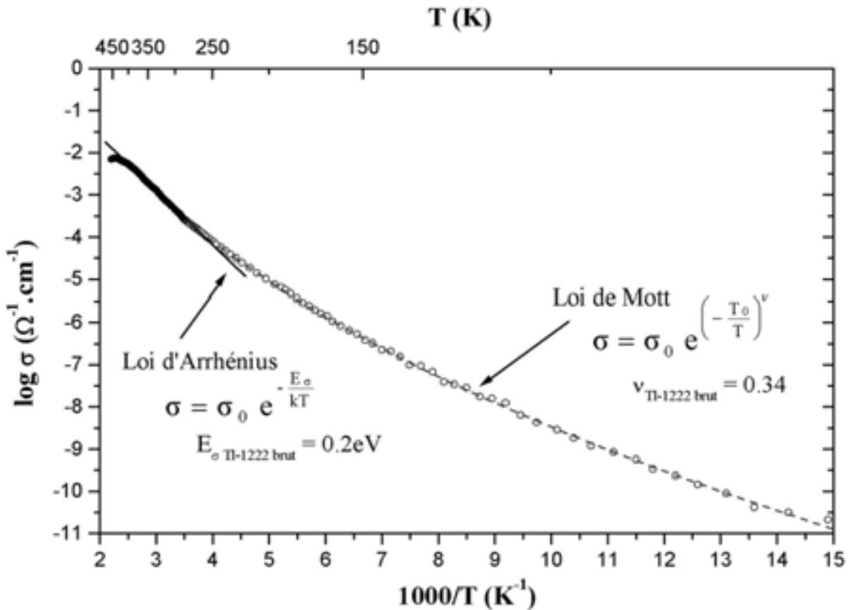
Figure V-8 : Variation du logarithme de la conductivité électrique de Tl-1222 brut en fonction de  $1000/T$ .
