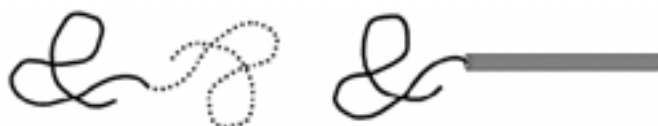
Figure 1 : Représentation schématique des architectures "flexible-flexible" et "rigide-flexible" dans le cas de copolymères diblocs
