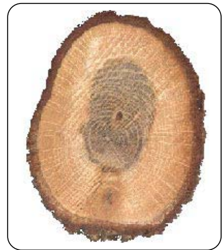
Fig.3.2 : Photographie d'une rondelle issue d'une branche de chêne à duramen irrégulier (épaisseur d'aubier variable et débordement du cœur vers le haut).
