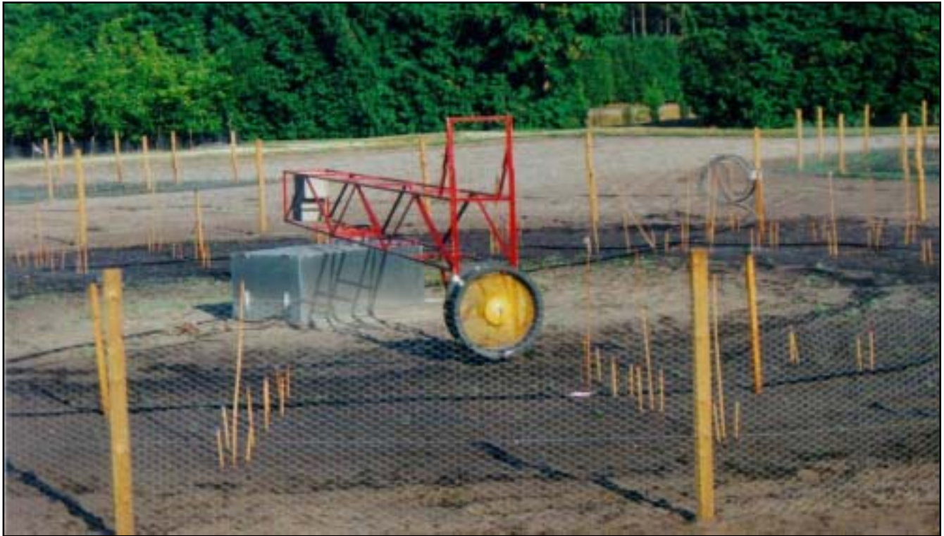
Fig.2.10a : Photographie du dispositif de ventilation rapide (dit "haute fréquence") en juillet 98 (le semis est récent et les plants artificiellement inclinés ne seront mis en place que l'année
