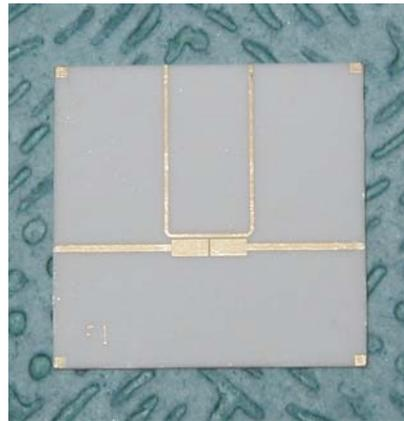
Figure 57 : Exemple de filtre demi-onde réalisé par des opérations de sérigraphie (filtre référencé f1cc au Chapitre II).
