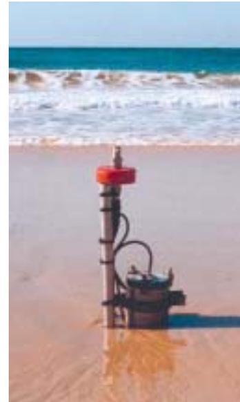
Figure III - 4: mise en place du courantomètre Aanderaa DCS3500. En arrière plan, la ville de Faro.
