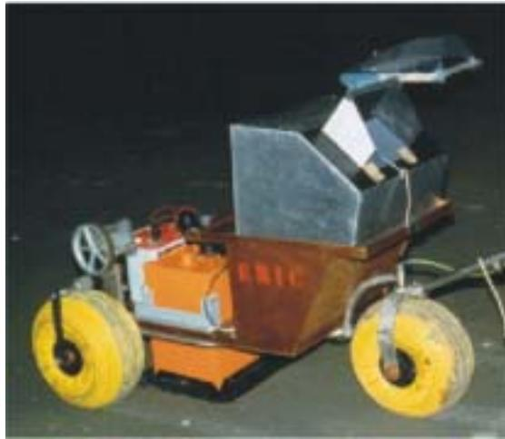
Figure III - 9: Détecteur compteur automatique (DCA) de grains fluorescents.
