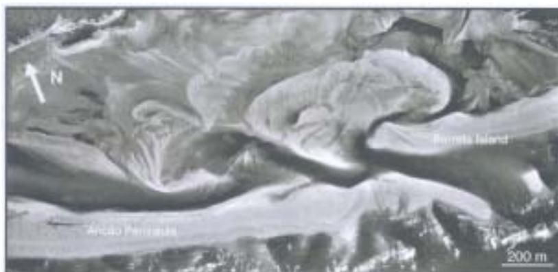
Figure II - 7: L'embouchure d'Ancao en 1989. Le chenal est fortement méandrique et on observe la formation de bancs dans l'embouchure. *The Ancao Inlet in 1989. Shoaling and meandering of the channel.*
