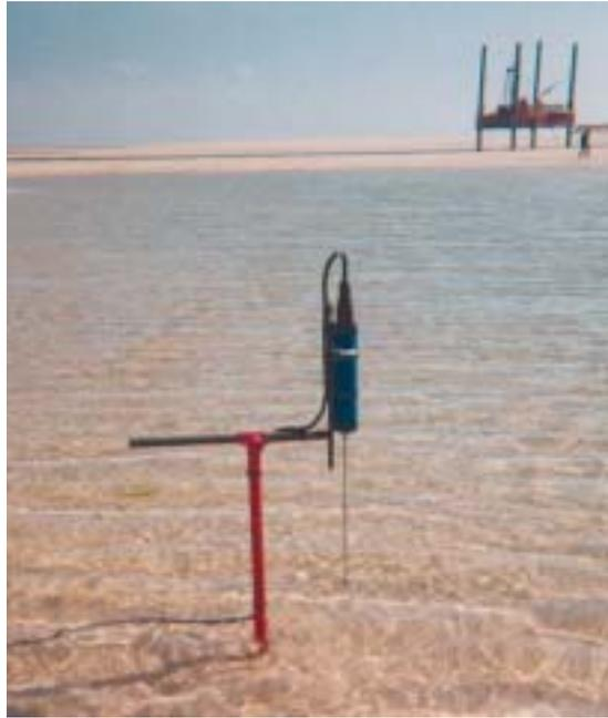
figure III - 5: Courantomètre ADV.
