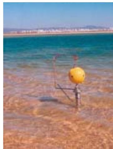
Figure III - 2: courantomètre S4 ADW à l'extrémité de la Péninsule d'Ancão.
