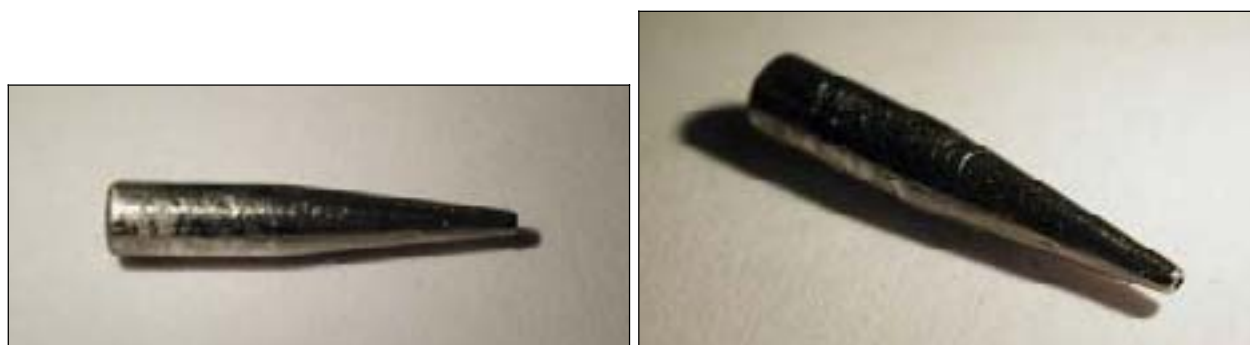
Figure I-19 – Clichés de la buse de filage (longueur : environ 1 cm, diamètre du conduit à l'extrémité : 300 \mu\text{m} ).
