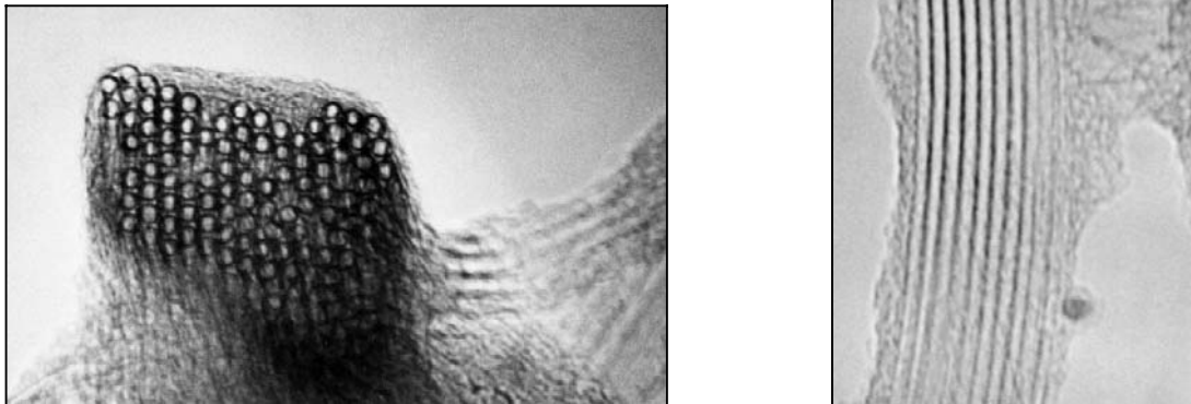
Figure I-4 – Clichés [Thess] (MET) de fagots de nanotubes monoparoi en coupe transversale (à gauche) et en vue longitudinale (à droite). Le diamètre de chaque nanotube est ici d'environ 1 nm.
