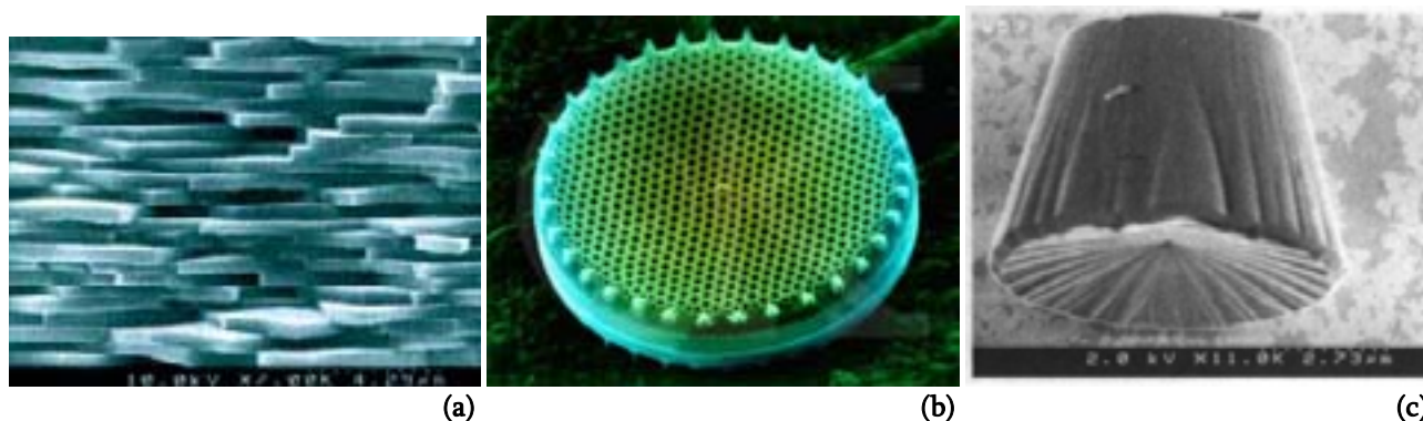
Figure I-13 – Clichés de microscopie électronique à balayage. (a) Structure de nacre de la coquille de l'huître Pinctada margaritifera (largeur de l'image = 15.3 μm). La composition chimique (aragonite/organique) de même que la structure stratifiée de cette nacre lui confère une grande résistance aux fractures. (b) Frustule de diatomée (x 950), algue unicellulaire produisant un exosquelette de silice à partir de particules de silicates. La forme, la symétrie et la grande porosité de cette coque lui permet de bien capter les éléments nutritifs qui lui sont nécessaires tout en laissant passer suffisamment de lumière à sa photosynthèse et en se protégeant du milieu environnant. (c) Particule de silice mésoporeuse créée en laboratoire par voie sol-gel (largeur de l'image = 10 μm). La silice, organisée autour d'un moule organique périodique – des micelles cylindriques de tensioactif arrangées de façon hexagonale – présente une grande surface spécifique ( \approx 1500 \text{ m}^2 \cdot \text{g}^{-1} ) ce qui en fait un candidat potentiel pour des applications de type catalyse ou extraction en phase solide.
