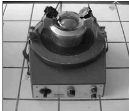
Figure II.3 Broyeur à boule vibrante
