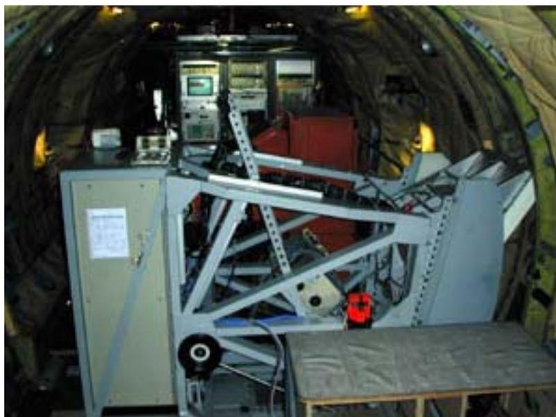
Figure 2.31 : Instrumentation SAR, antenne et électronique d'acquisition
