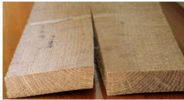
Figure IV. 22 : Fentes de bout dans le bois juvénile.
