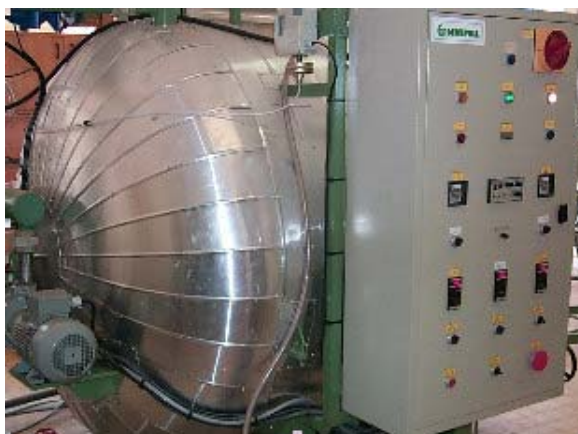
Figure IV. 5 : Séchoir MASPELL avec son tableau électrique.
