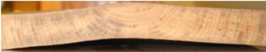
Figure IV. 19 : Tuilage sur une planche fissurée sur dosse.
