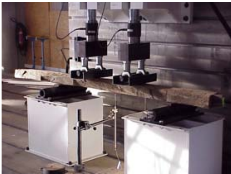
figure 3 : Photographie d'un essai statique (flexion 4 points) sur une poutre en chêne au CTBA.
