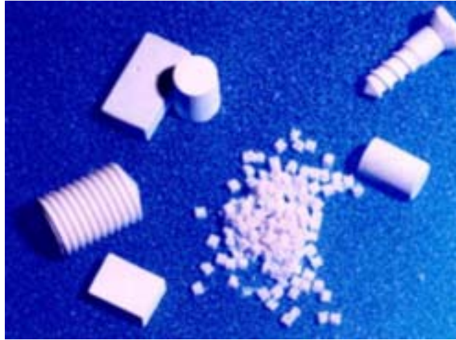
Schéma 13 : Biomatériaux d'hydroxyapatite
