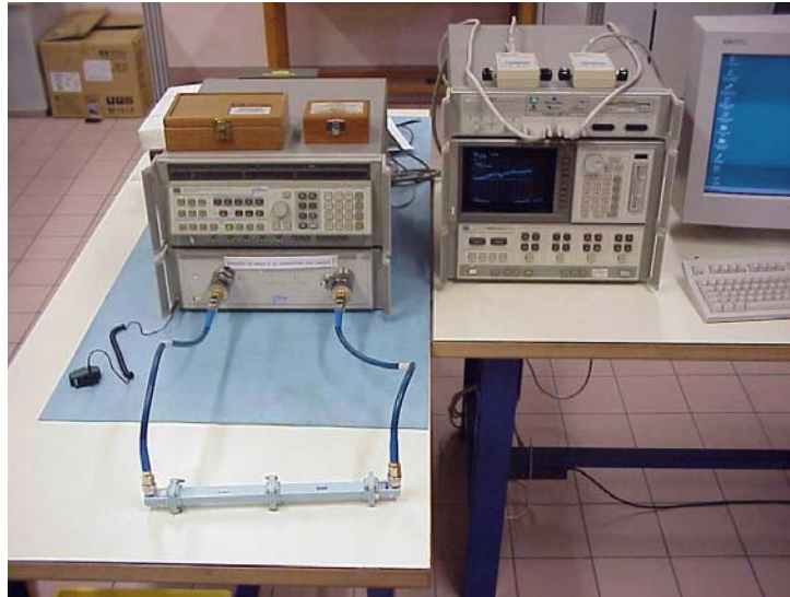
Figure II.19 : Dispositif expérimental de mesure en réflexion/transmission.
