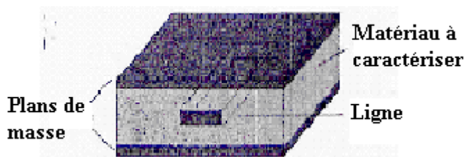
Figure II.9 : Géométrie de la ligne triplaque.
