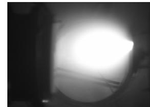
Figure I-12 : " plume " vaporisée par ablation laser.
