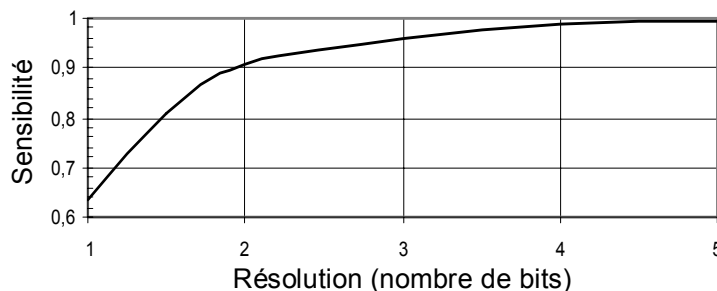
Figure 4.01 : Sensibilité maximale d'un CAN à la fréquence de Nyquist.
