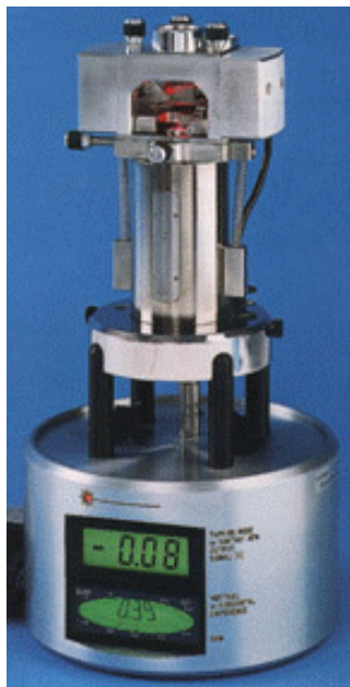
FIG. 3.4 – Microscope à champ proche utilisé au laboratoire : Nanoscope IIIa de Digital Instrument. Hauteur : 30cm
