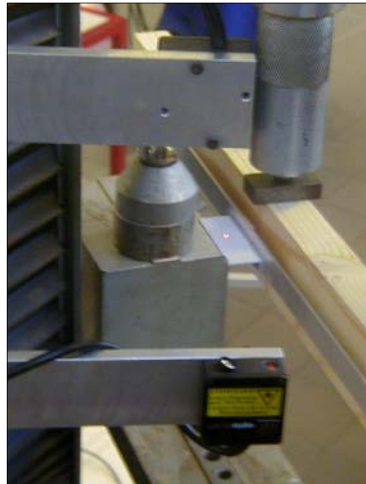
Fig. A1.4 : Système de mesure de déplacement en flexion 3 points par triangulation laser.
