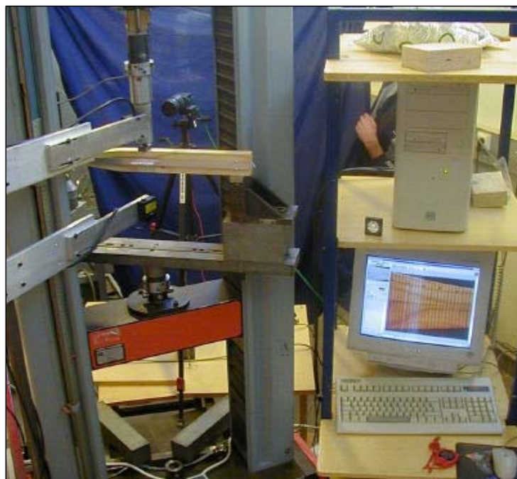
Fig. A1.5 : Montage expérimental de flexion 3 points associant l'extensométrie laser et l'acquisition d'images.
