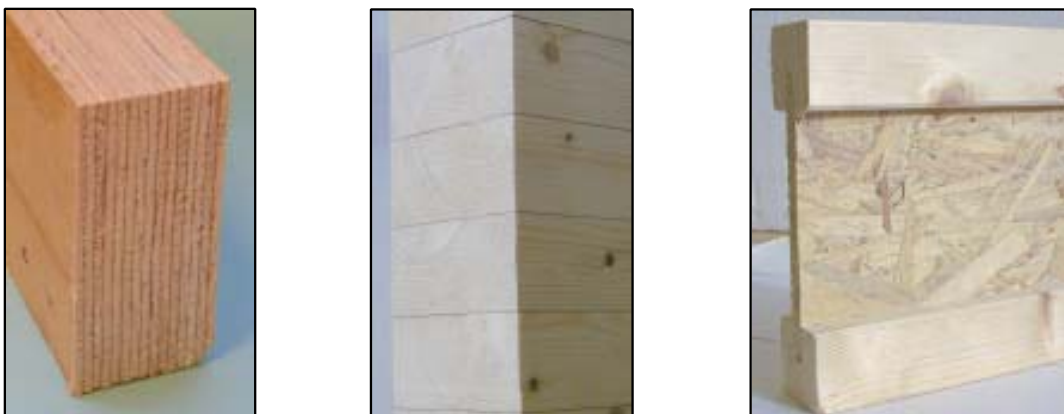
Fig.I.2 : Bois reconstitué collé couramment utilisé en construction bois : le LVL (Laminated Veneer Lumber), le Lamellé collé , poutre en I.
