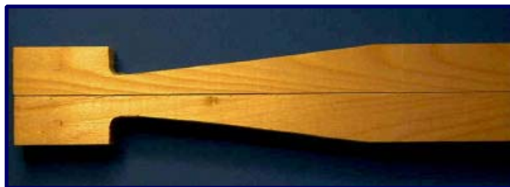
2ème configuration de collage: fil du bois convergent vers le plan de collage
