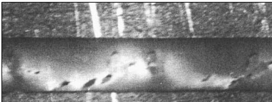
Fig. 2.7 : Propagation d'une fissure dans un joint collé sollicité en cisaillement ; Développement de microfissures en avant du front de fissure réel [129].
