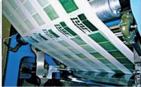
Fig. 4.47 – Impression par technique jet d'encre sur substrat papier (vitesse 100 m/min)
