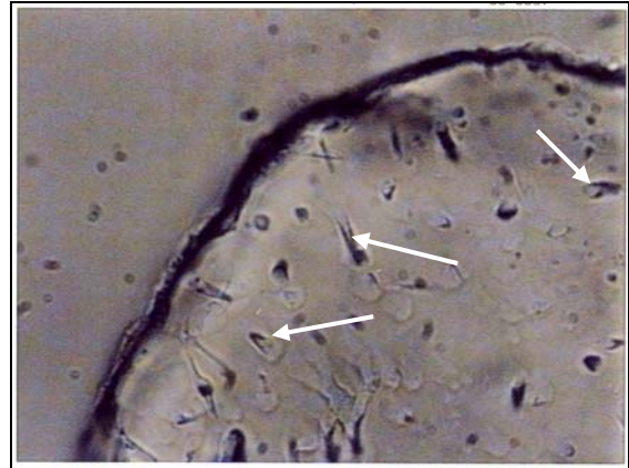
Traces de fission surattaquées par HNO_3 ODZ-1bis(10X100)
