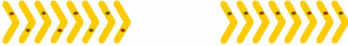
Figure 4.4 – Organisations possibles dans les couches smectiques des molécules bananes avec un seul atome résonant. A gauche : les molécules s'arrangent de façon à alterner la position de l'atome résonant. A droite : Les molécules s'arrangent de façon à aligner les atomes résonants;
