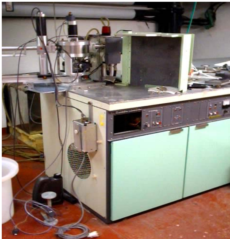
Figure 2.3 – Photo de l'anode tournante de 18 kW au CRPP;
