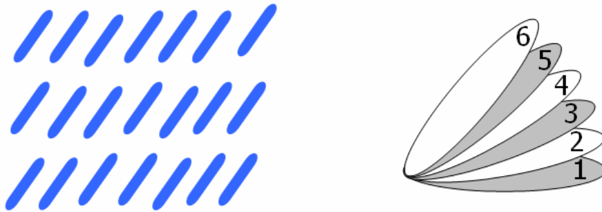
Figure 1.5 – Représentation de la phase Smectique C*. La chiralité produit une torsion spontanée des molécules d'une couche à l'autre. À droite on voit une représentation de la projection du directeur sur le plan des couches (les nombres représentent les couches);
