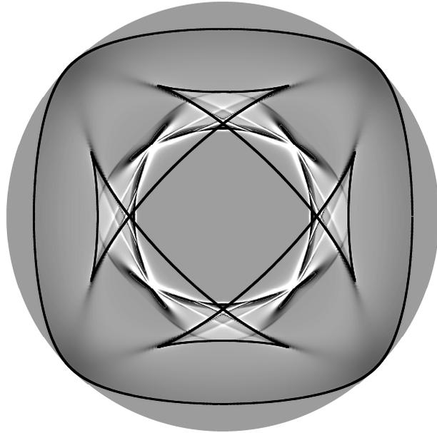
*figure II-18 Comparaison des vitesses de l'énergie des ondes rasantes dans le plan homogènes avec la réponse élastodynamique calculée par la fonction de Green.*
