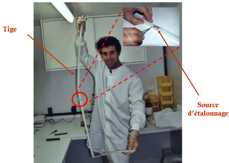
FIG. 3.1 – Tige plastique de 3 mètres de longueur accueillant trois sources ^{207}\text{Bi} .
