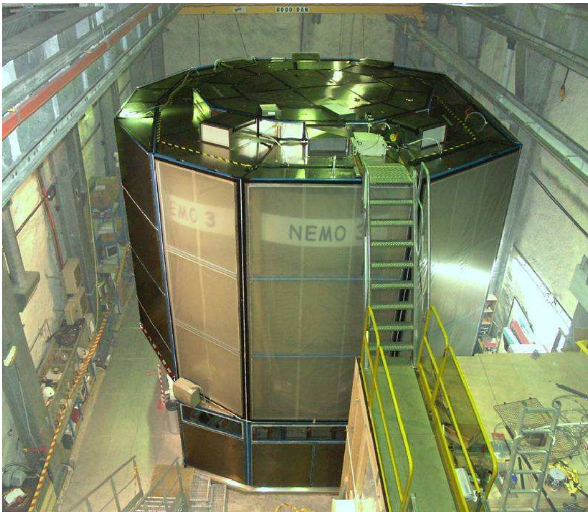
FIG. 2.17 – Le détecteur NEMO 3 entouré de la tente anti-radon dans le hall du LSM.
