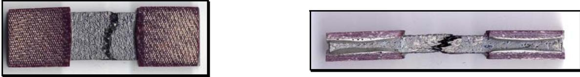
Figure II-8: Barreau en SEPCARBINOX® A500 équipé de talons en résine après sollicitation en traction avec cycles de charge-décharge à  $T_a$ , vues de face (gauche) et de côté (droite).
