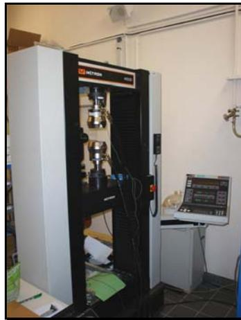
Figure II-9 : Machine de traction à  $T_a$  INSTRON 4505.
