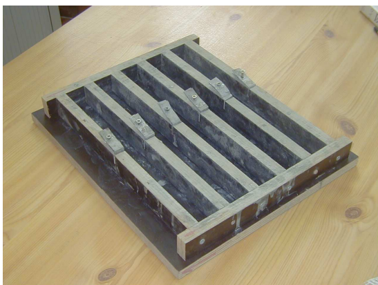
FIG. II.4 : Des moules en contreplaqué sont utilisés pour couler, d'une pièce, les plus petits échantillons.
