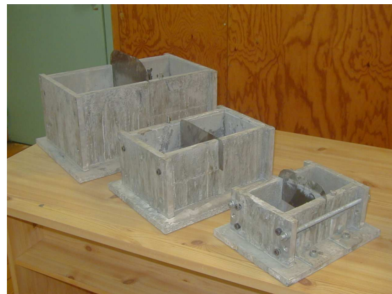
FIG. II.5 : Moules en aluminium ayant servi à réaliser le coeur des plus gros échantillons. Une feuille d'acier calibrée permet de créer l'entaille.
