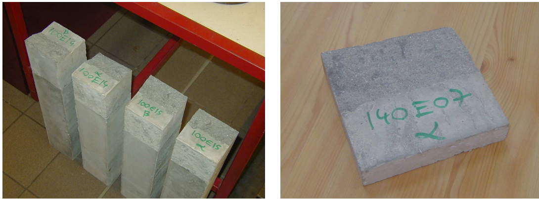
FIG. III.1 : Les demi-éprouvettes sont sciées pour ne conserver qu'une mince plaquette.
