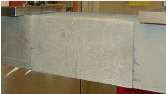
FIG. II.6 : Afin de faciliter la réalisation et la manutention des éléments les plus lourds, ceux-ci sont coulés en trois parties puis assemblés par collage.
