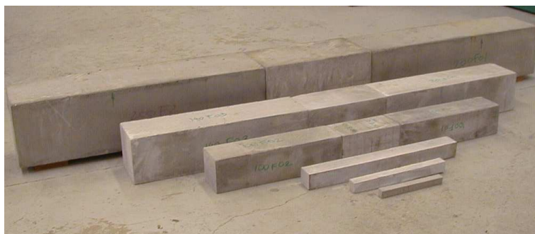
FIG. II.2 : 6 tailles d'échantillons ont été testées : 20, 30, 50, 100, 140 et 200 mm.
