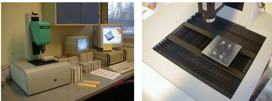
FIG. III.3 : Vue d'ensemble de la station de rugosimétrie et vue rapprochée des tables de déplacement.
