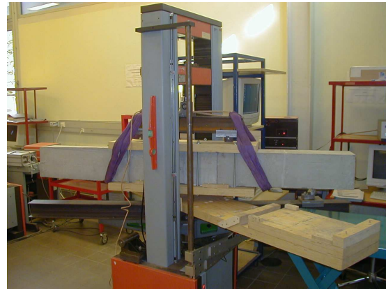
FIG. II.7 : Éprouvette lors de sa mise en place sur le bâti de flexion. La presse est utilisée pour lever les échantillons les plus lourds à l'aide de sangles. Une bride boulonnée protège son coeur entaillé.
