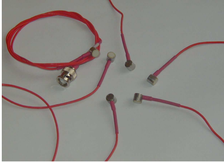
FIG. II.12 : 6 capteurs piézoélectriques de diamètre 8 mm et de fréquence de résonance 300 kHz ont été utilisés.
