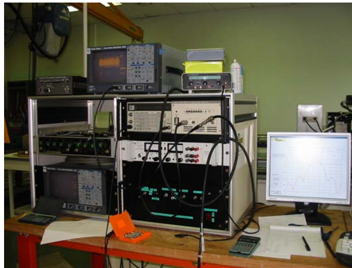
figure 4 : Chaîne de réception de l'hydrophone : amplificateur et oscilloscope .
