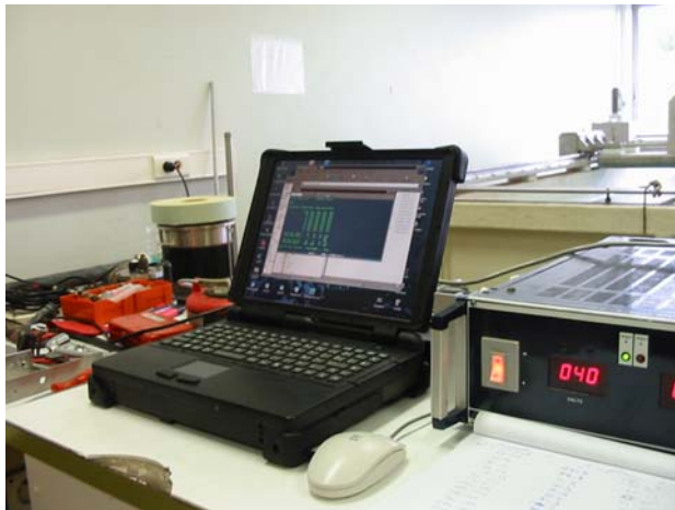
figure 5 : PC et alimentation stabilisée, connectés à l'ADCP dans le bassin (arrière plan).
