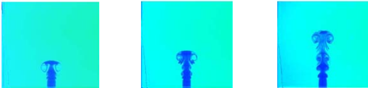
Fig. 81. Images de fluorescence dans les premiers instants de l'injection ( t_0+110ms , 150ms , 220ms )
