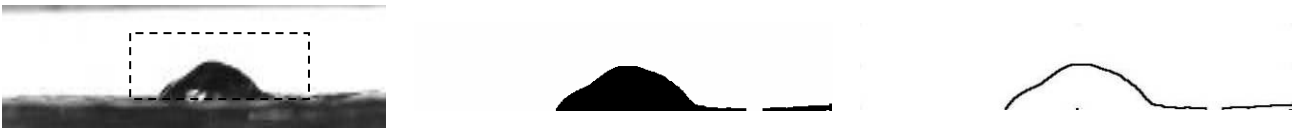
Fig. 80. Images de l'interface en ombroscopie et traitement (sélection d'une zone d'intérêt, seuillage et filtrage de Sobel)
