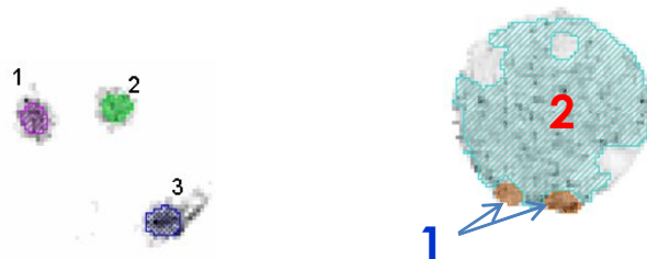
Figure 5.16 : Distribution des concentrations élémentaires dans le plan de coupe analysé. Les concentrations moyennes (en mg/g) sont reportées à titre indicatif pour chaque microsphère (notées bille 1, 2, 3 comme indiqué sur le schéma au-dessus) et pour les deux régions significativement différentes dans la distribution du chlore (notées 1 et 2).
