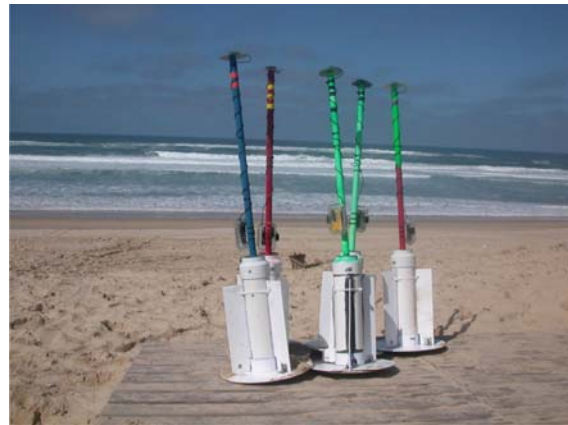
Figure 7b : dériveurs lagrangiens déployés par la NPS
