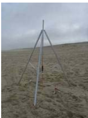
Figure 4a : pénétrömètre dynamique (EPOC)
