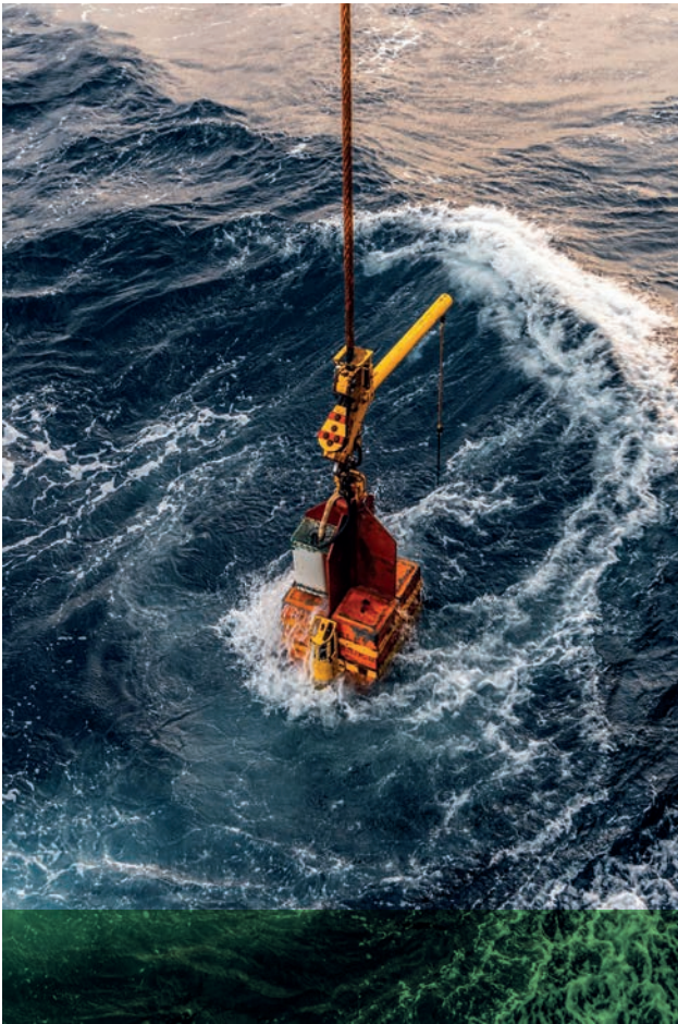
Immersion du carottier géant Calypso lors de la campagne Amaryllis (juin 2023) depuis le navire océanographique Marion-Dufresne. Avec une capacité de carottage en routine de plus de 50 mètres, le Marion-Dufresne de la Flotte Océanographique Française est un instrument unique au monde. Les carottes prélevées lors de la campagne océanographique Amaryllis documenteront la variabilité hydrologique tropicale du bassin de l'Amazone.
