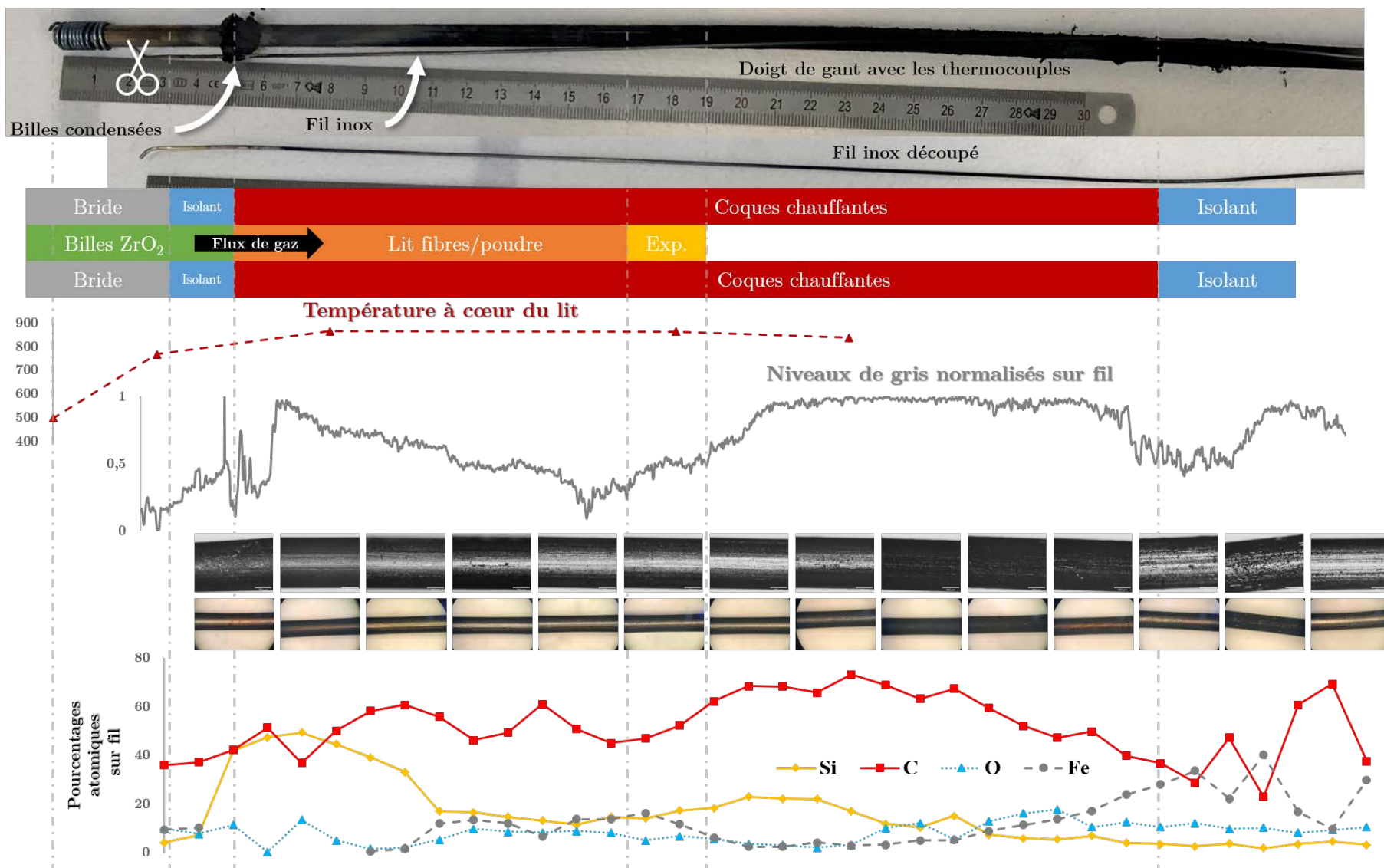
FIGURE 6.24 – Caractérisation du dépôt sur fil inox pendant une expérience de dépôt \text{Si}_x\text{C}_y ex-TES.
