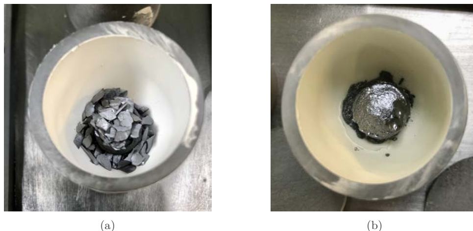
FIGURE 7.13 – Images des creusets chargés a) avant et b) après MI.
