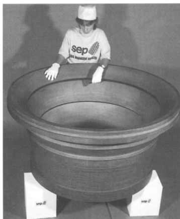
FIGURE 1.23 – Col en C/C du MPS du booster de Ariane V après usinage. [60]
