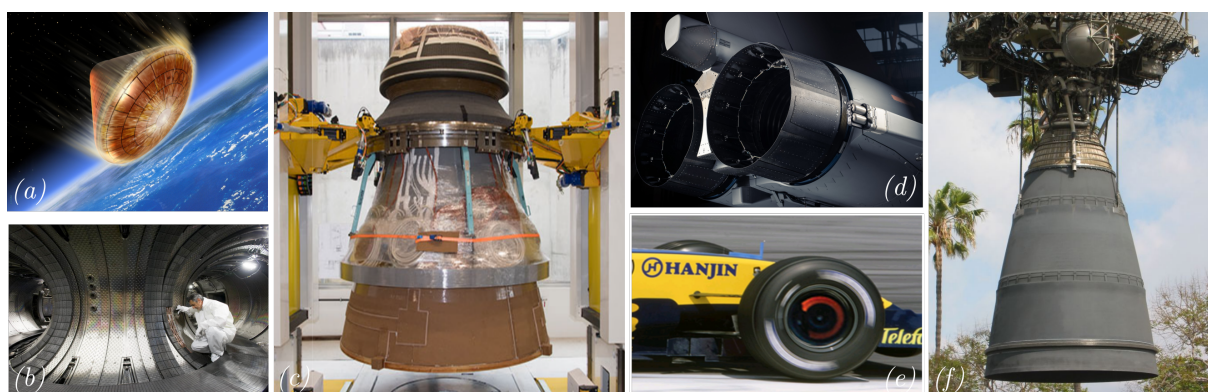
FIGURE 1.19 – (a) Véhicule de rentrée atmosphérique (Source : ESA). (b) Armure du Tokamak Tore Supra (Source : CEA Cadarache). (c) Tuyère du moteur à propergol solide P120, avec au sommet son col en C/C (Source : ArianeGroup). (d) Volets du moteur M-88 (Source : Safran Aircraft Engines). (e) Freinage d'une monoplace en F1 (Source : Renault). (f) Divergent rétractable du moteur RL10B-2 du deuxième étage de la fusée SLS (Source : NASA).
