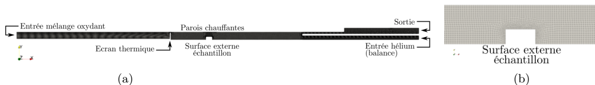
FIGURE 2.18 – Géométrie et maillage du modèle CFD de l'ATG sur ANSYS Fluent . (a) Géométrie globale. (b) Raffinement du maillage autour de l'échantillon.
