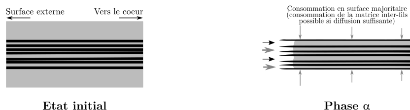
FIGURE 3.11 – Scénario de comportement à l'oxydation temps-température de la nuance A-37 en régime limité par la diffusion ( T \leq 1000^\circ\text{C} ).
