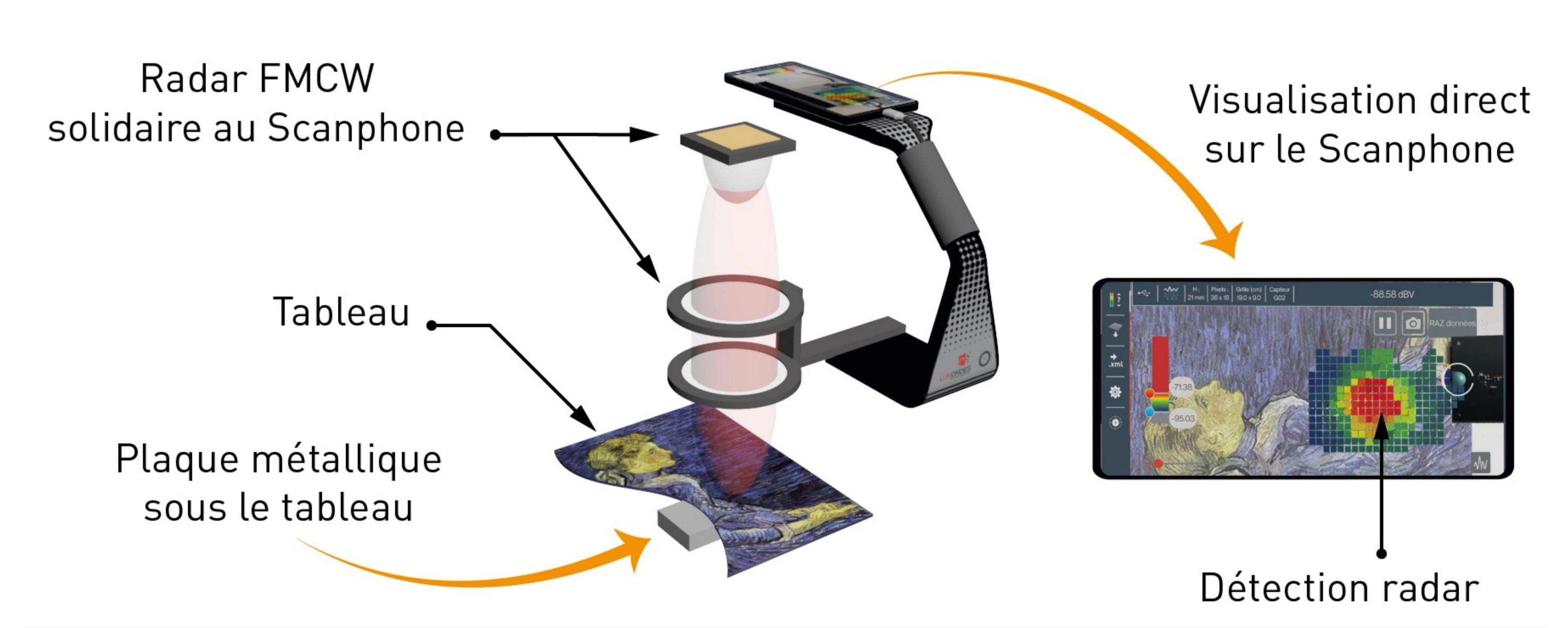
Le montage expérimental, illustré sur le schéma ci-dessus, associe un radar FMCW large bande intégré (122 GHz à 170 GHz), deux lentilles de 115 mm de focale et un smartphone (Scanphone/Luxondes) utilisant une interface de réalité augmentée. Une plaque métallique (4x8cm) est placée sous la peinture à l'emplacement de la bouche.
