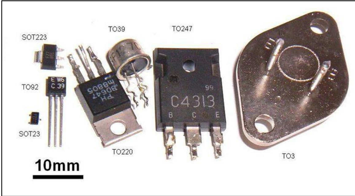
الصورة (5): مجموعة من الترانزستورات مختلفة الشكل والوظيفة على مقياس واحد.
