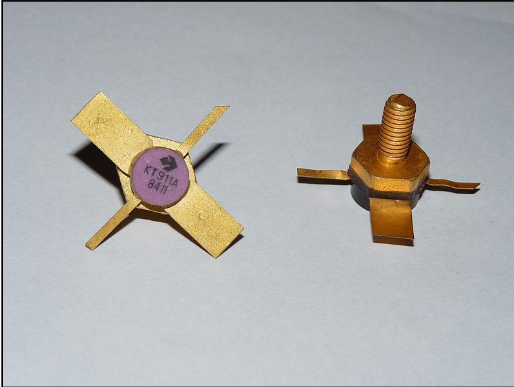
الصورة (12): ترانزستور سيليكوني من النوع NPN من العائلة KT911A، مصنوع في الاتحاد السوفيتي.
