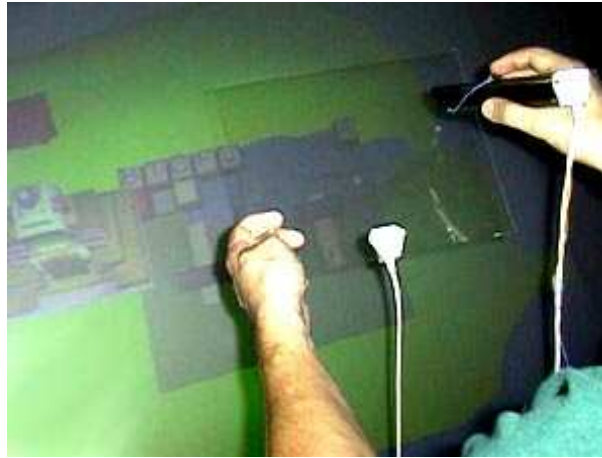
Figure 6: Interaction 2D dans un EV au moyen d'une tablette transparente
